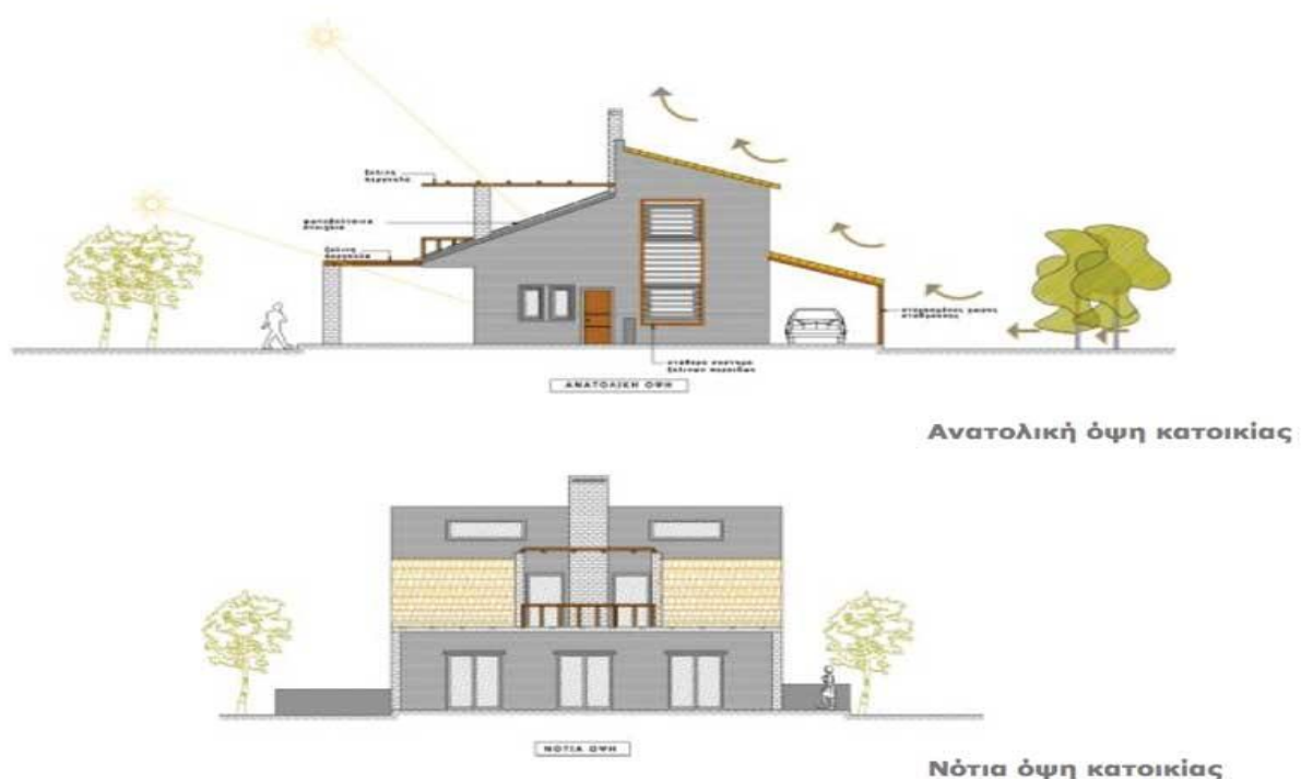
Εικόνα 44 Συμβολή σκιάστρου ανάλογα τον προσανατολισμό.
