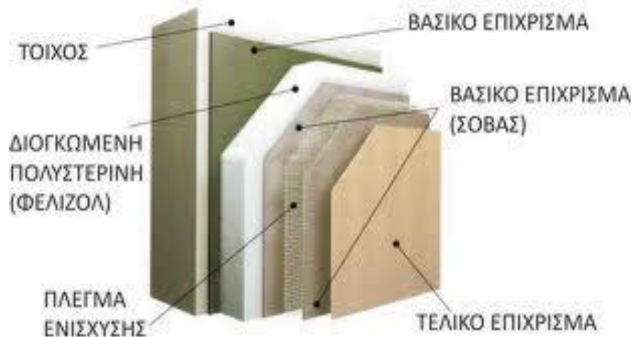
Εικόνα 33 Τομή εσωτερικής θερμομόνωσης.
