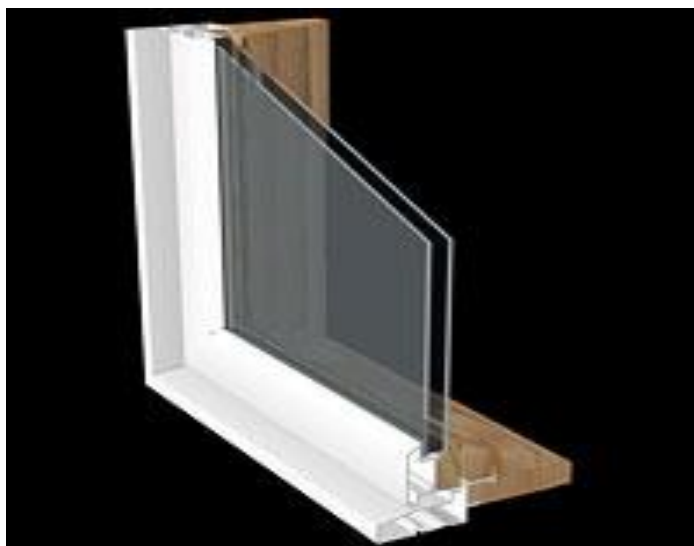
Εικόνα 5 Τομή κουφώματος clad.
